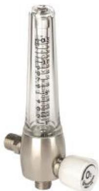
Flussimetro ad area variabile per il dosaggio dell'ossigeno; scala da 0 - 15 l/min, può essere connesso alla rete di distribuzione del gas medicale tramite idonei innesti in accordo alle normative AFNOR NF S 90-116, DIN 13260-1, UNI 9507, BS 5682 o filettatura G 1/4" M DX; come optional è possibile acquistare un adattatore G1/4" - 9/16" maschio.
