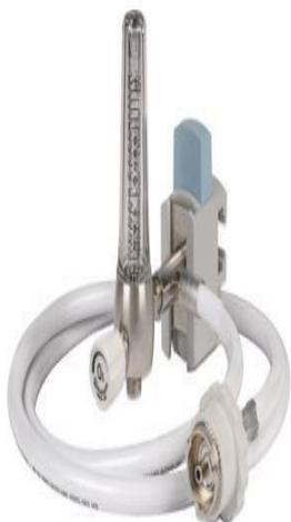
Flussometro ad area variabile per il dosaggio dei gas medicinali per l'alloggiamento sulla barra porta strumenti; scala da 0 - 15 l/min; può essere connesso alla rete di distribuzione del gas medicale tramite idonei innesti in accordo alle normative AFNOR NF S 90-116, DIN 13260-1, UNI 9507, BS 5682, SS 8752430, filettatura G 1/4" M DX, disponibili per l'ossigeno anche con innesto a 90°, completo di morsetto in ABS per fissaggio su barre portastrumenti.
