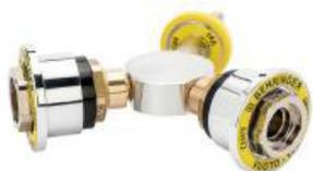
Sdoppiatore prese UNI 9507 completo di due prese gas specifiche, un innesto gas specifico per la connessione nella presa a muro e corpo in alluminio anodizzato; idoneo a soddisfare l'esigenza di raddoppiare una singola utenza.
