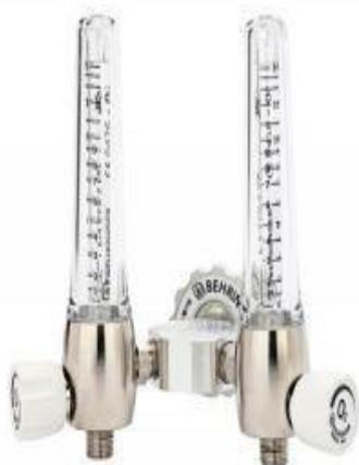
Flussometro doppio ad area variabile per il raddoppio della singola utenza, composto da due flussometri 0-15 l/min; può essere connesso alla rete tramite innesti tipo AFNOR NF S 90-116, DIN 13260-1, UNI 9507, BS 5682, filettatura G 1/4" M DX.
