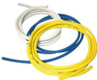
Tubo in gomma medica, conforme alla normativa EN ISO 5359, formato da cinque strati: il più interno è in PVC antistatico, esternamente troviamo uno strato di PVC il quale è contenuto in un layer di polyester che svolge una funzione di rinforzo, gli ultimi due strati sono nuovamente in PVC ed il più esterno dei due è colorato in modo specifico in base al gas di utilizzo.
