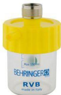
Il vaso di sicurezza si installa a valle del regolatore di vuoto RVB per proteggere l'impianto di aspirazione ed il regolatore stesso dalle impurità; esso in ingresso presenta una connessione a portagomma mentre si collega al regolatore di vuoto per mezzo di una filettatura G 1/2" F DX. Il dispositivo è costituito da un vaso in policarbonato con capacità di 150 cc oppure 300 cc e da un tappo con uscita a portagomma.
